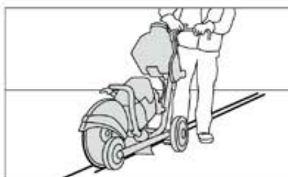
Kladenie signálnych káblov do zeme.
